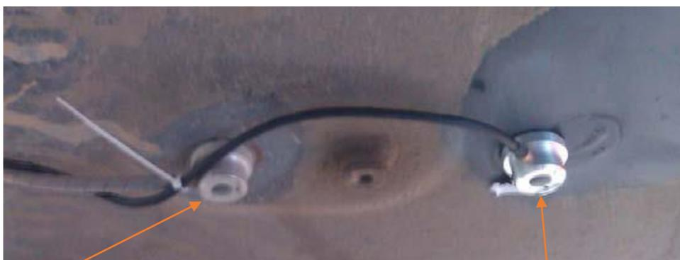
FALSCH eingebauter Sensor am Ablass!
